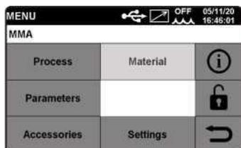
**Process** ВЫБОР СВАРОЧНОГО ПРОЦЕССА, СВАРКА МЕТАЛЛИЧЕСКИМ ЭЛЕКТРОДОМ В ИНЕРТНОМ ГАЗЕ или РУЧНАЯ ДУГОВАЯ СВАРКА МЕТАЛЛИЧЕСКИМ ЭЛЕКТРОДОМ (см. объяснение в разделе «Процесс сварки металлическим электродом в инертном газе»).
