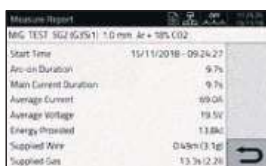
Встроенная система мониторинга процесса сварки
