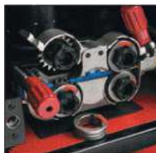
4-х роликовый (диам. 37 мм) механизм протяжки сварочной проволоки промышленного класса.
