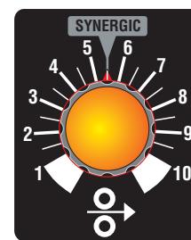
Lorsqu'on utilise un programme synergique quelconque, l'aiguille de ce bouton doit être placée sur l'inscription SYNERGIC. Lorsqu'on choisit un programme synergique, le display **H** affiche le courant défini. Ce courant correspond à une vitesse; pour la corriger, il suffit de tourner le bouton en sens horaire pour l'augmenter, ou bien en sens inverse pour la réduire.
