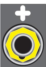
Met deze aansluiting moet de losse laskaabelkoppeling van de tussenkabel worden verbonden (positieve pool +).
