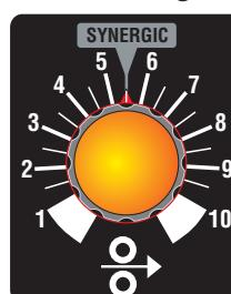
Når man anvender et hvilket som helst synergisk program, skal knappen viser være anbragt på SYNERGIC. Når man vælger et synergisk program, viser displayet **H** den indstillede strøm. Denne strøm svarer til en hastighed, og kan ændres ved at dreje knappen med uret for at øge, eller mod uret for at sænke.
