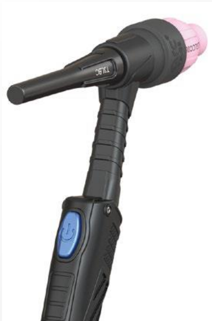
Сварочная горелка премиум класса ARC T3/T3FX с газо-воздушным охлаждением 35% ПВ при 240A DC, 170A AC
