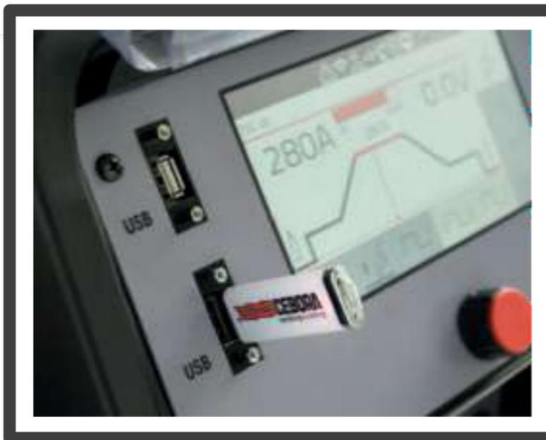
7" LCD тач-скрин для отображения и настройки всех параметров источника. 2 шт USB-порта для сохранения данных в т.ч. из системы промышленного мониторинга, для обновления программного обеспечения
