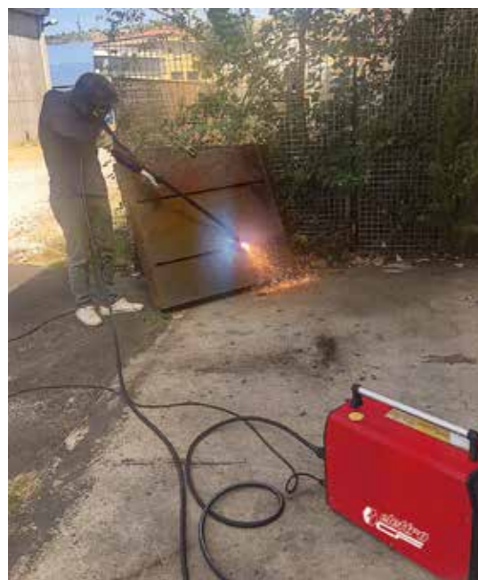
Codice - Code 535472 Torcia plasma manuale ECF-131 con inclinazione a 15°, impugnatura da 0,80 m e connessione EASY FIT ECF-131 manual plasma torch with 15° inclination, 0.80 m grip and EASY FIT connection
